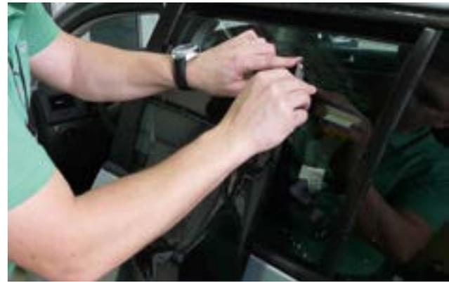
**Anmerkung:** Bei der Verlegung wird die Folie ein bis zwei Millimeter runtergeschoben, so dass sie unter die Gummidichtung reicht.
